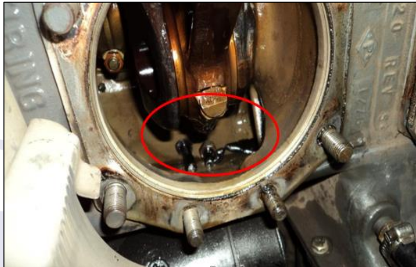
Figura 2 - Parafusos da biela n 3 encontrados dentro do bloco do motor.
