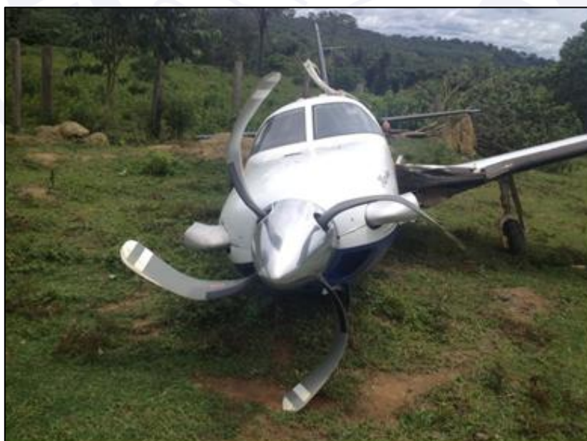
Figura 1 - Vista frontal dos danos à aeronave.
