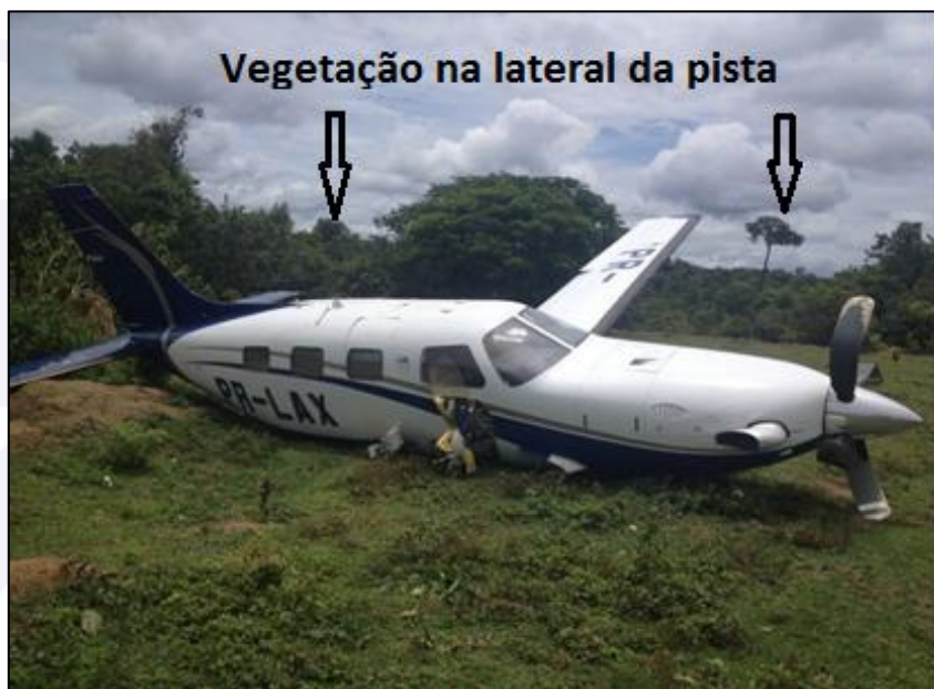
Figura 2 - Vista lateral dos danos e da vegetação na lateral da pista.
