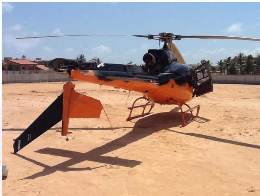
Figura 1 - Vista geral da aeronave avariada.
