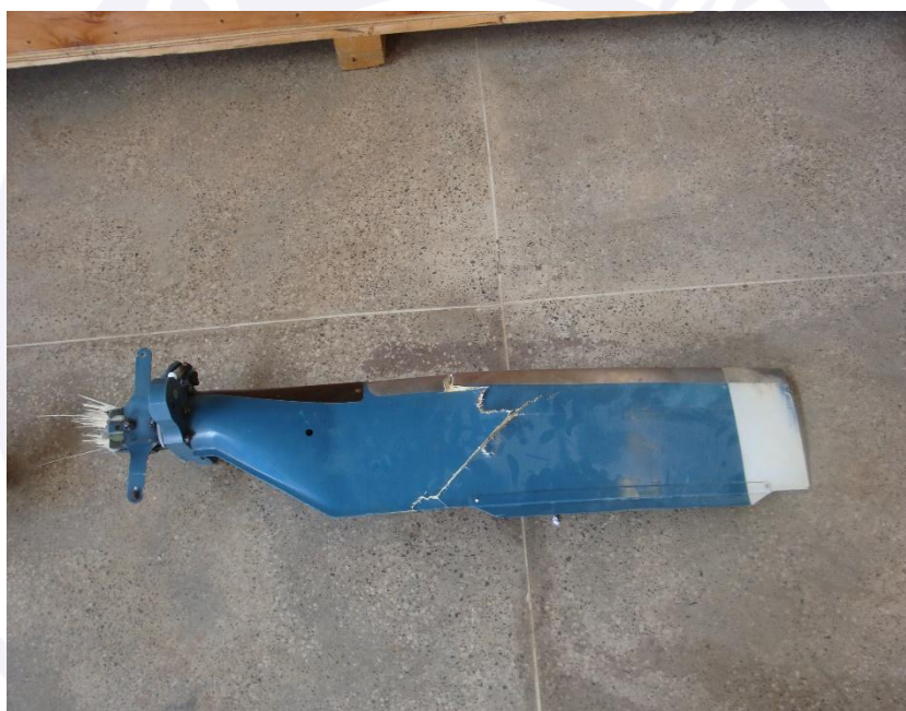
Figura 2 - Vista da pá do rotor de cauda danificada.
