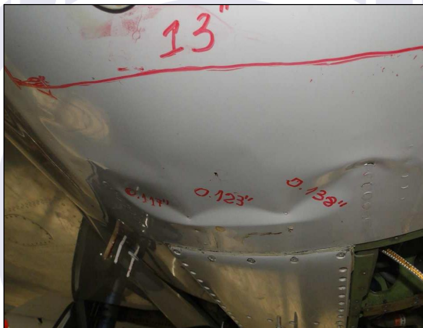
Figura 1 - Danos estruturais na parte inferior da fuselagem da aeronave durante a recuperação da perda de controle em voo.
