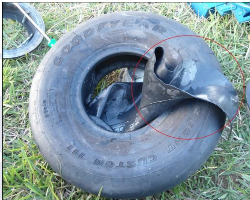
Figura 5 - Câmara de ar do pneu principal direito danificada.
