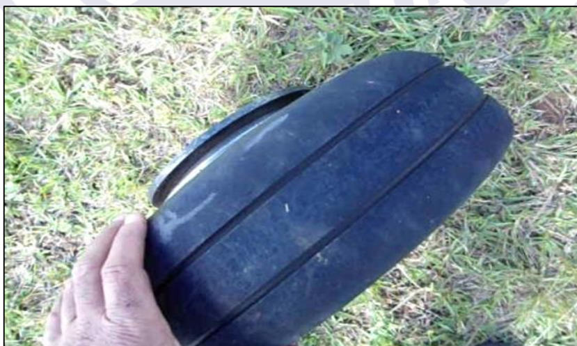
Figura 4 - Pneu principal direito em boas condições.
