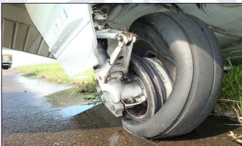
Figura 3 - Pneu principal direito desencaixado do cubo de roda.
