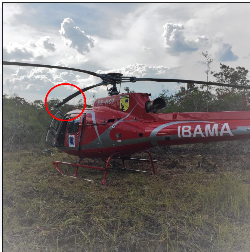
Figura 2 - Visão geral da aeronave e dano à ponta da pá do rotor principal.
