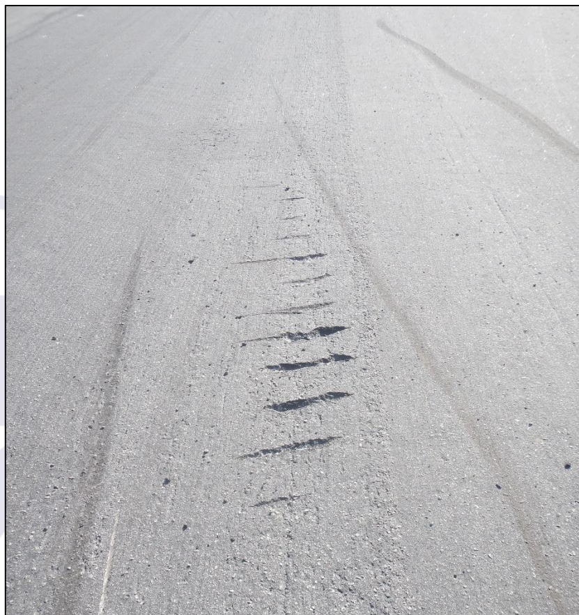
Figura 1 - Marcas do impacto da hélice contra o solo.
