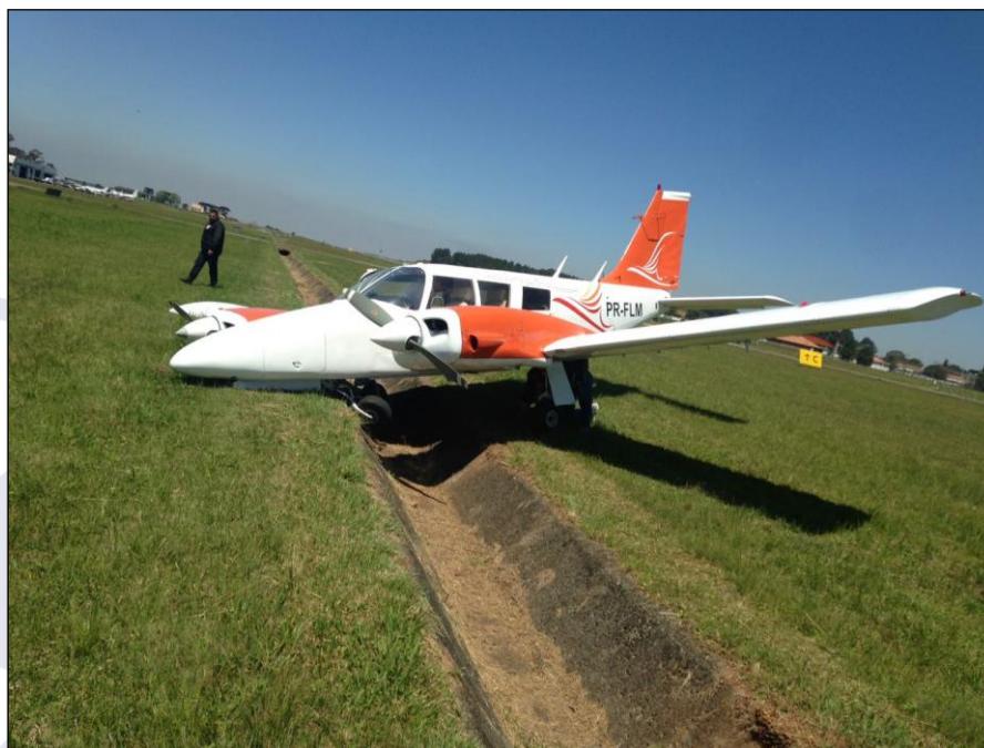
Figura 2 - Posição final e danos à aeronave após a colisão com a vala de drenagem.
