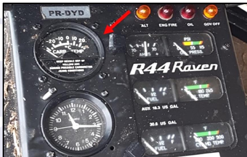
Figura 5 - Painel do PR-DYD, com destaque para o instrumento “Carb temp”.
