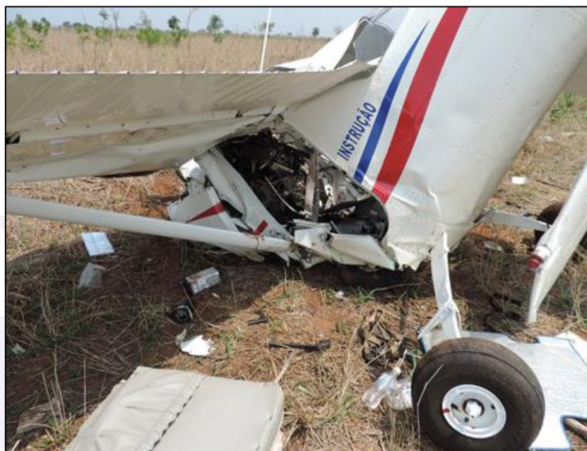
Figura 2 - Danos ao motor e à cabine da aeronave.
