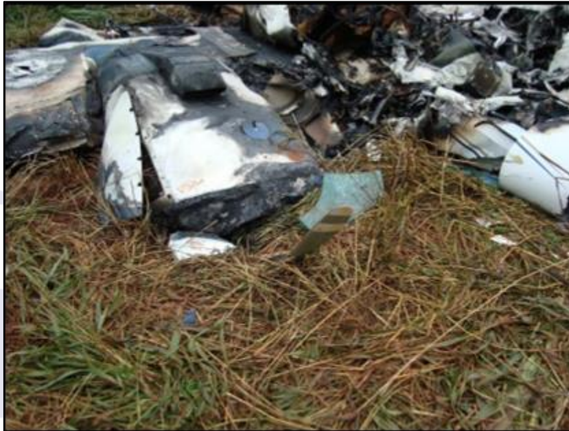
Figura 2 - Detalhe da hélice direita cravada verticalmente no solo e das deformações na carenagem do motor direito.
