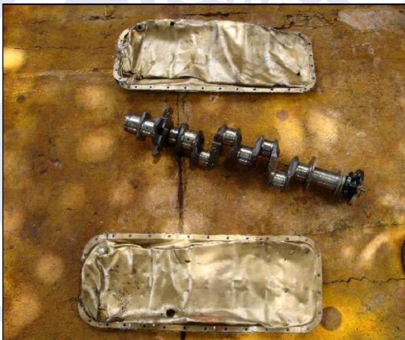
Figura 3 – Detalhes dos cárteres dos motores amassados.
