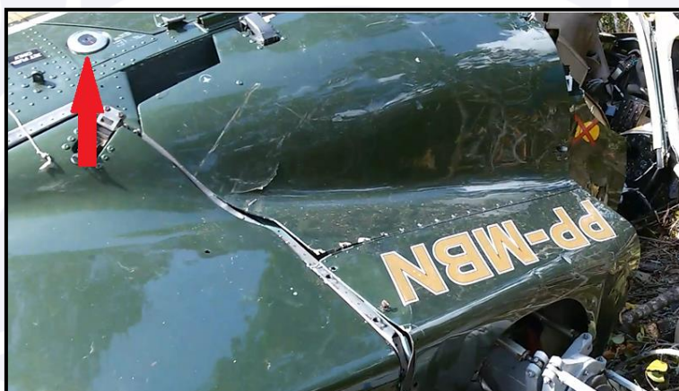
Figura 10 - Bocal do reservatório preservado.
