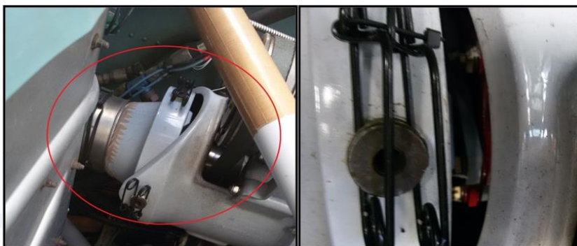
Figura 6 - Conexão entre o motor e a CTP.
