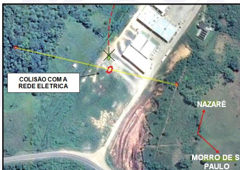
Figura 17 - Croqui do local da decolagem/colisão com fio.
