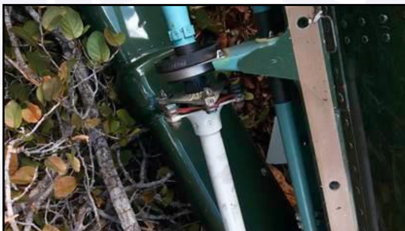
Figura 7 - Acoplamento do eixo de ligação com o eixo de acionamento do rotor de cauda.
