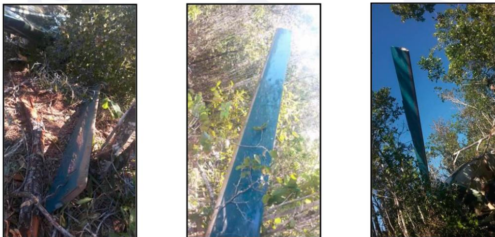
Figura 3 - Pás do rotor principal sem impacto no bordo de ataque.
