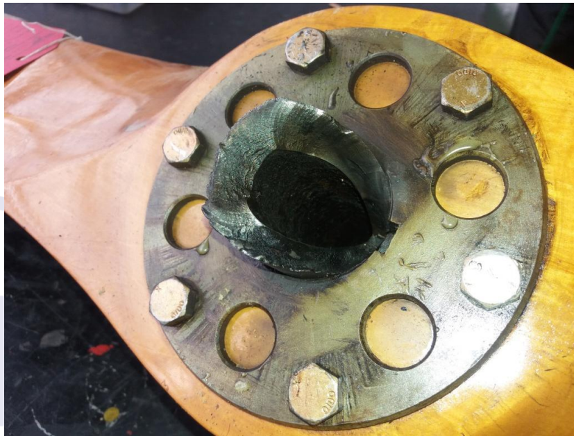
Figura 2 - Detalhe da fratura no cubo da hélice.
