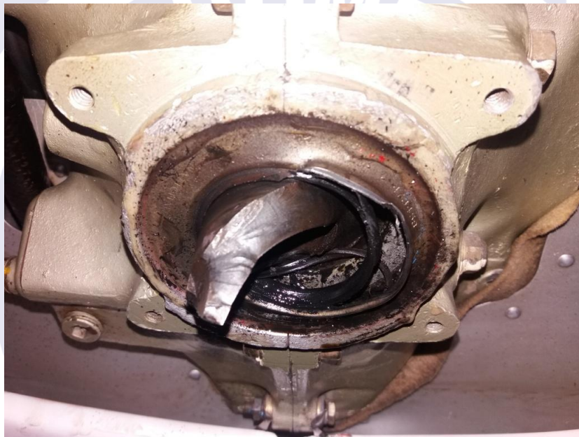
Figura 3 - Detalhe da fratura no eixo da hélice.
