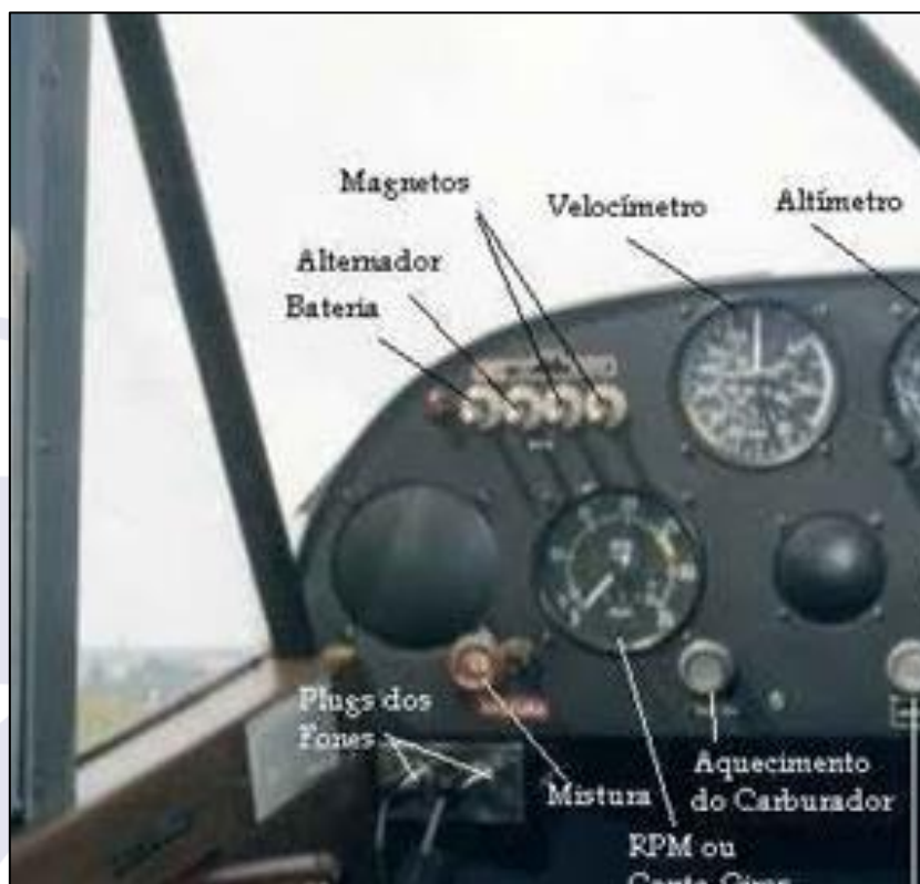
Figura 2 - Painel da aeronave mostrando a posição dos interruptores.
