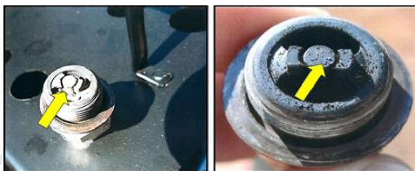
Figura 3 - Condição de contaminação das velas inferiores - cilindros 2 e 4.
