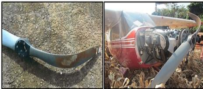
Figura 2 - Condição da hélice após o acidente.
