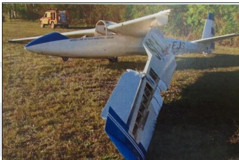
Figura 3 - Danos à asa esquerda.
