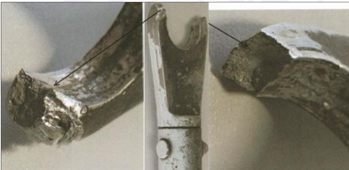
Figura 3 – Detalle de la ruptura por sobrecarga del Tube Assy-Aft Push-Pull del tren de aterrizaje derecho.
