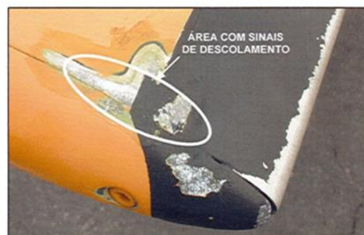
Figura 5 – Aspecto da área crítica na superfície superior ( upper skin ) da pá P/N C016-7.
